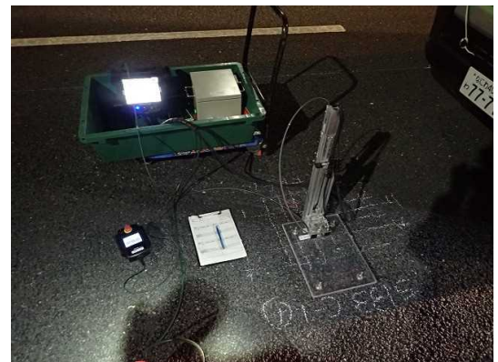
図－１０ エンコーダとファイバースコープを使用した削孔内壁面の観察・記録
