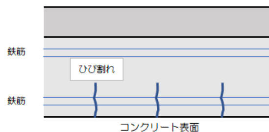
一般的なひび割れ：表面に直角に生じる
